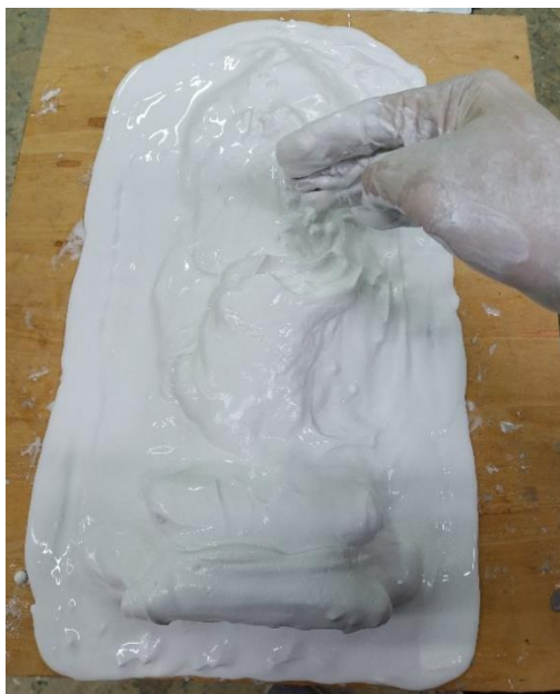
ภาพที่ ๙๔ ขั้นตอนการการทำพิมพ์ครอบด้วยปูนพลาสติก และเพิ่มความแข็งแรงชั้นที่ ๒ ด้วยการผสมใยมะพร้าวผสมปูนพลาสติก ที่มา ผู้วิจัยและคณะผู้วิจัย
