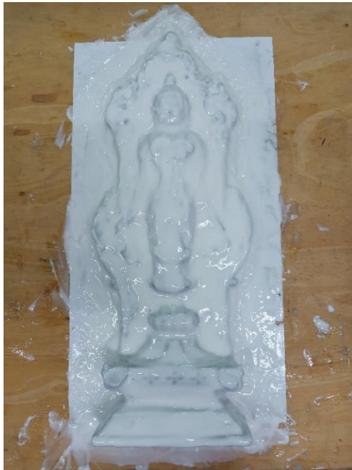
ภาพที่ ๙๓ ขั้นตอนการการทำแม่พิมพ์ยางซิลิโคน ทางยางซิลิโคน ๒ ชั้น และปูผ้าก๊อซผ้าซุมยางซิลิโคน ที่มา ผู้วิจัยและคณะผู้วิจัย
