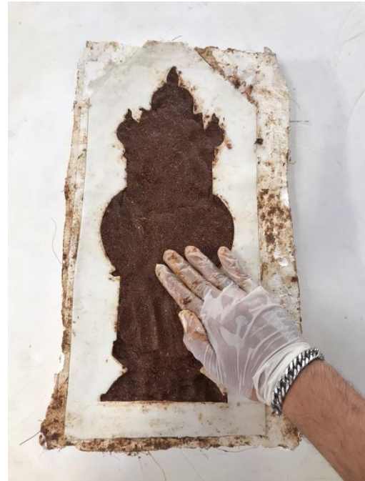
ภาพที่ ๑๐๓ ใส่ผงดอกไม้ให้เต็มแม่พิมพ์ยางซิลิโคน และกดให้แน่นเพื่อไม่ให้เกิดฟองอากาศ ที่มาจากผู้วิจัยและคณะผู้วิจัย
