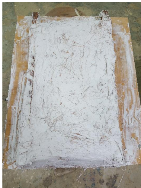
ภาพที่ ๙๔ ขั้นตอนการการทำพิมพ์ครอบด้วยปูนพลาสติก และเพิ่มความแข็งแรงชั้นที่ ๒ ด้วยการผสมใยมะพร้าวผสมปูนพลาสติก ที่มา ผู้วิจัยและคณะผู้วิจัย
