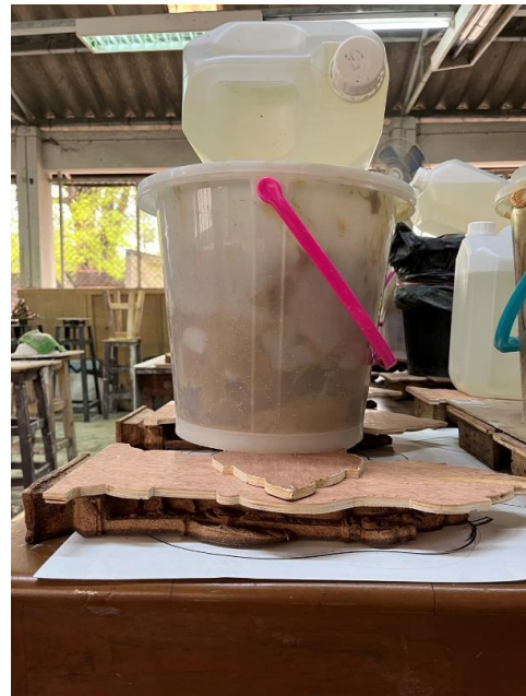
ภาพที่ ๑๓๗ การแก้ปัญหาด้วยการยึดกับโต๊ะ ภาพที่ ๑๓๘ การแก้ปัญหาด้วยการใช้วัสดุที่มีน้ำหนักกดทับ ที่มา ผู้วิจัยและคณะผู้วิจัย ที่มา ผู้วิจัยและคณะผู้วิจัย
