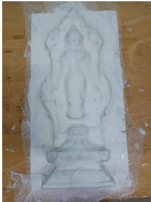
ภาพที่ ๙๓ ขั้นตอนการการทำแม่พิมพ์ยางซิลิโคน ทางยางซิลิโคน ๒ ชั้น และปูผ้าก๊อซผ้าซุมยางซิลิโคน ที่มา ผู้วิจัยและคณะผู้วิจัย
